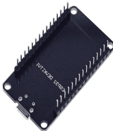
Si vous possédez un NodeMCU ESP32, la figure suivante montre à quoi il ressemble (il est indiqué NodeMCU ESP-32S).
