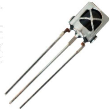
fig 17.2 : capteur IR
