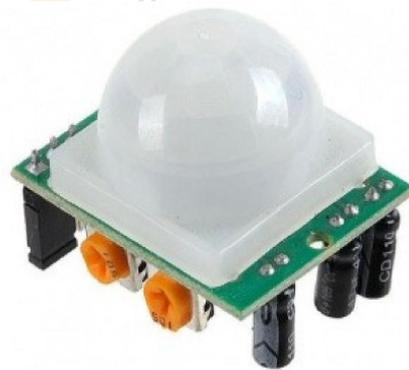
fig 13.1 : capteur de mouvement PIR
