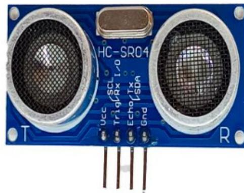
fig 10.1 : Capteur à ultrasons
